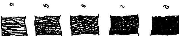
*a* - начальное окисление поверхности; *b* - общее окисление поверхности; *c* - заметное окисление, *d* - сильное окисление, *e* - интенсивная коррозия
